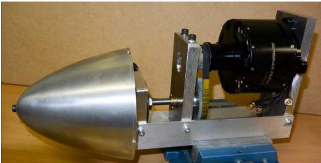
Der Motor von Hobby King leistet mit getriebe 2400 U/Min. am Propeller
